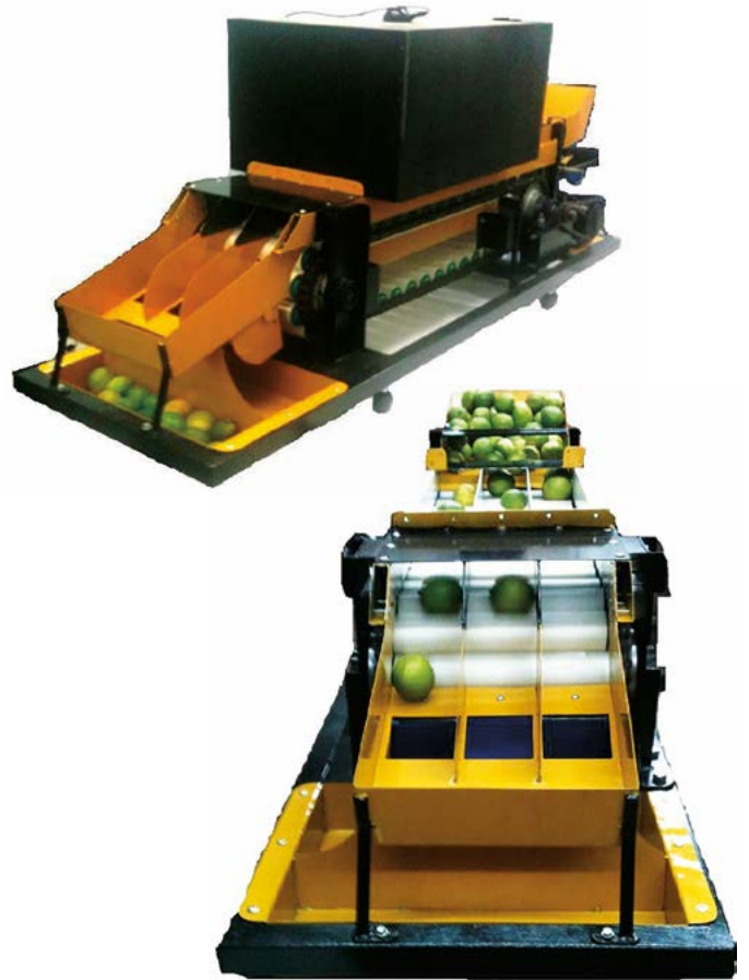
Figura 6. Sistema de selección de limón persa por tonalidad.
