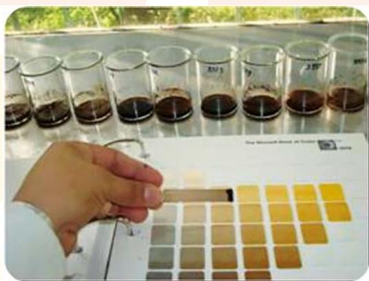
**Figuran 4.** Determinación del color con pirofosfato de sodio.
