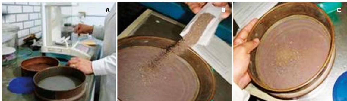
**Figura 3.** Secuencia para cuantificar el material parcialmente descompuesto y material fibrico: a) pesar una porción de abono orgánico, b) tamizar y c) pesar lo que quedó retenido en el tamiz.
