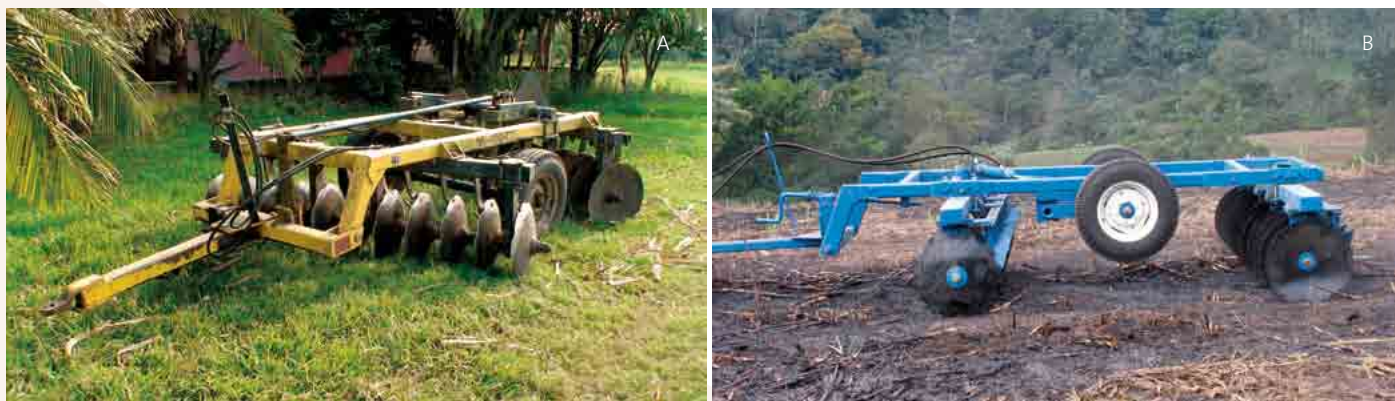
Figura 2. A: Rastra de discos excéntrica del tipo de tiro. B: Cuerpos de la rastra de disco convencional excéntrica en configuración paralela y perpendicular con la dirección de movimiento del tractor.
