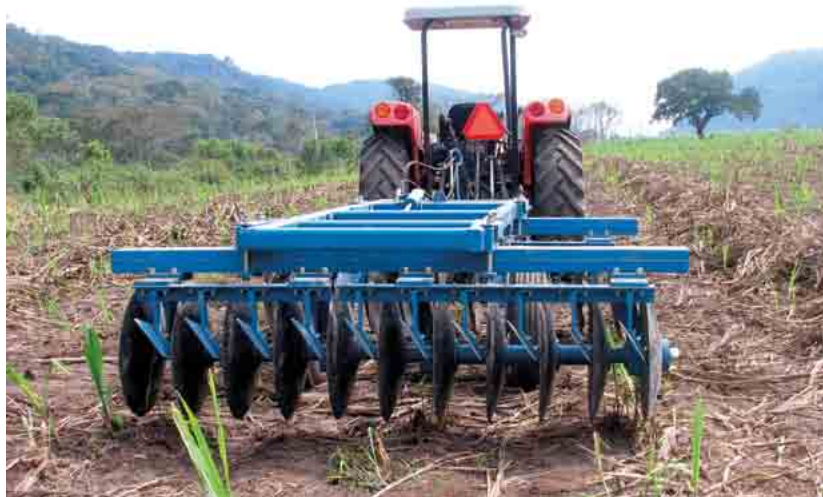
Figura 5. “Rastra fitosanitaria” en operación en un cañaveral con surcos de 1.20 m de ancho. El ancho de trabajo no es suficiente para cubrir por completo los surcos extremos, así como la inacción de los discos que cubren el fondo del surco.
