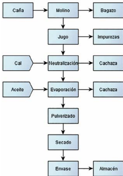
Figura 4. Diagrama del proceso de elaboración de panela granulada en el trapiche establecido en el Colegio de Postgraduados Campus Córdoba.
