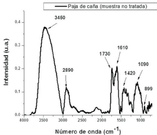
Figura 2. Interferograma de la muestra de paja, donde los picos muestran los componentes de celulosa, hemicelulosa y lignina.
