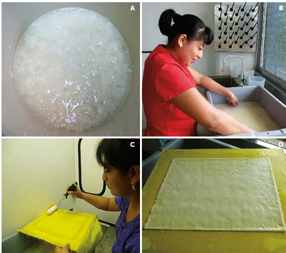
Figura 3. Proceso de elaboración de papel artesanal con fibra de celulosa blanqueada. A: Pulpa de celulosa hidratada. B: Formación de hoja. C: Eliminación de exceso de humedad. D: Hoja de papel húmeda.
