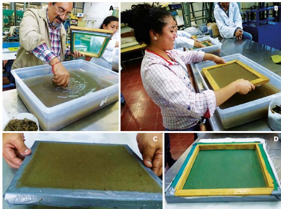
Figura 4. Proceso de elaboración del papel artesanal con fibra de celulosa. A: Disolución de la fibra de celulosa en agua. B: Extracción del bastidor con la hoja formada. C: Separación del soporte del bastidor. D: Colocación de la hoja sobre la hoja de tela.
