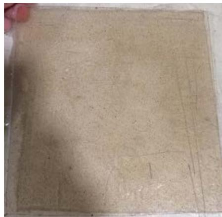
Figura 6. Biocompuesto elaborado de PLA con 2% de MFC.
