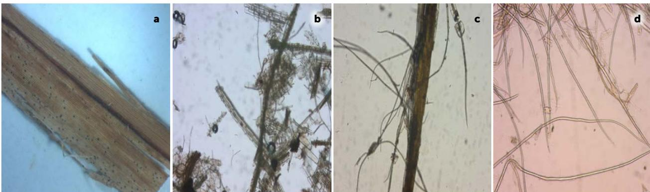
**Figura 4.** Micrografías de a) fibra de la paja de caña de azúcar (*Saccharum* spp.) sin tratamiento, b) fibras de celulosa después de la cocción con hidróxido de sodio 100X, c) fibras de celulosa después de la desfibrilación, y d) fibra de celulosa después del blanqueo y refinado a 10X.
