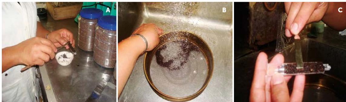
**Figura 1.** Secuencia en la determinación de fibra no frotada: a) llenar la media jeringa con el abono humedecido, b) lavar con una corriente de agua sin frotar y c) cuantificar la fibra no frotada.
