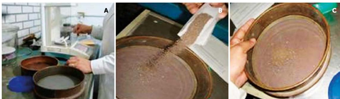
**Figura 3.** Secuencia para cuantificar el material parcialmente descompuesto y material fibrico: a) pesar una porción de abono orgánico, b) tamizar y c) pesar lo que quedó retenido en el tamiz.
